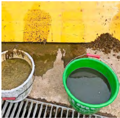
Test an der Schalttafel: Dünngülle vom Separator, Vollgülle, stark verdünnte Laufstallgülle, Feststoffe des Separators (von links nach rechts). Bild: Milada Quarella
