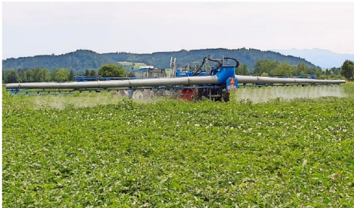
Eine Feldspritze mit Luftunterstützung hilft, möglichst überall einen schützenden Belag aufzutragen.
