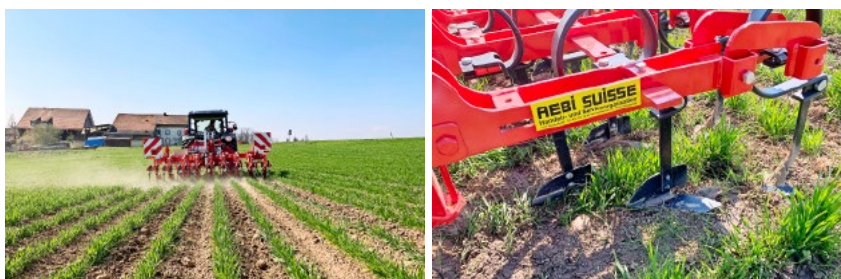
Zweiter Hackdurchgang von Weizen in weiter Reihe mit einem kameragesteuertem Hackgerät der Firma Einböck. Entlang der Reihen laufen Winkelmesser, mittig wird ein Gänsefusschaar eingesetzt. Der Durchlass pro weite Reihe beträgt ca. 8 cm, die Fahrgeschwindigkeit betrug auf vorliegendem Feld 6–8 km/ha (6 km bei stärkerer Hangneigung). Bilder: Viktor Dubsky, Strickhof
