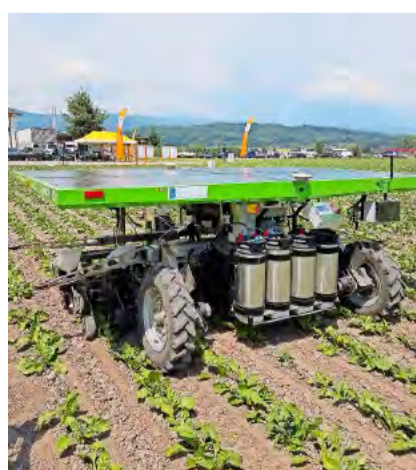
Der Farmdroid kombiniert die Saatarbeit und Unkrautregulierung. Bild: Samuel Jenni, SFZ
